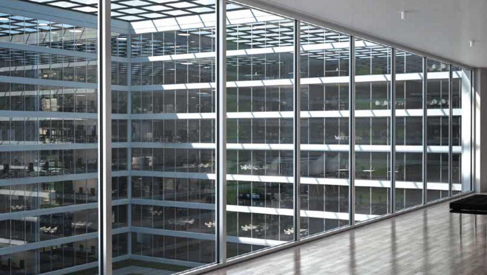
Mit Festverglasungen Schüco FireStop ADS 90 FR 90 können Elemente bis zu einer Höhe von 3500 mm gebaut werden. In der Breite sind die Elemente unbegrenzt. Selbst der Einbau von Türen in Verglasungen lässt mit dem System eine Gesamthöhe bis zu 3500 mm zu.
